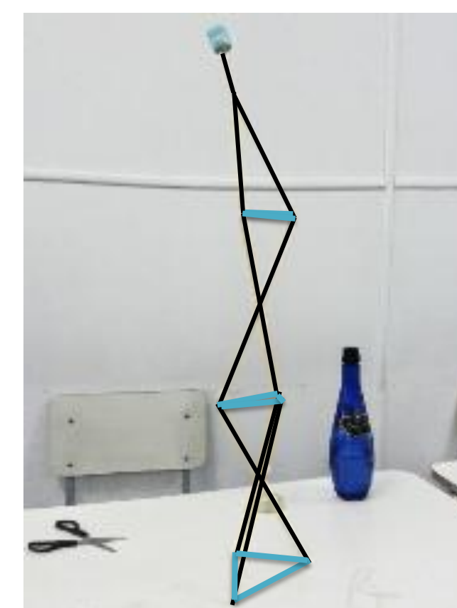
Projeto final das torres demonstrando técnicas de engenharia bastante avançadas. Detalhe para a última torre que faz uso de barbantes (linhas azuis), como sistema de tração similar a tirantes de pontes.
