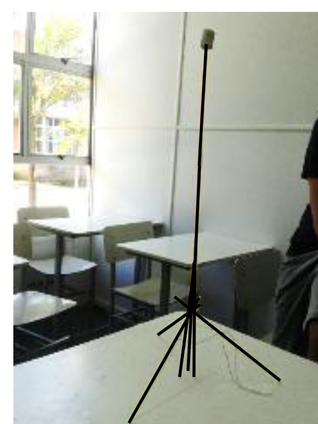
Projeto final das torres demonstrando técnicas de engenharia bastante avançadas. Detalhe para a última torre que faz uso de barbantes (linhas azuis), como sistema de tração similar a tirantes de pontes.
