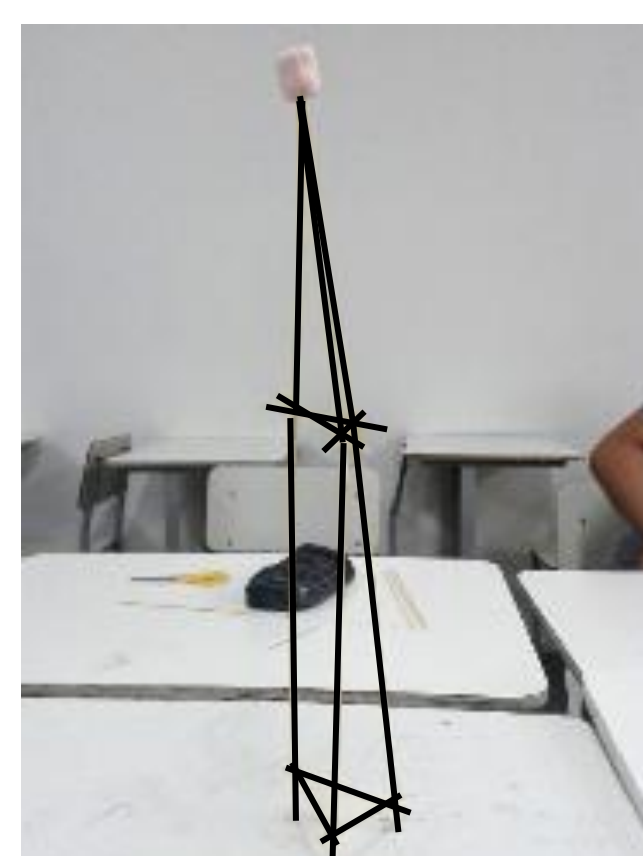
Projeto final das torres demonstrando técnicas de engenharia bastante avançadas. Detalhe para a última torre que faz uso de barbantes (linhas azuis), como sistema de tração similar a tirantes de pontes.
